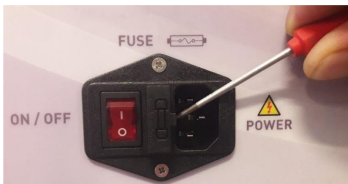
Рисунок 67. Вскрытие блока предохранителей
