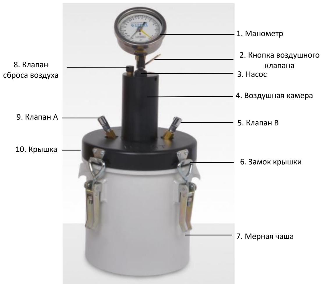
Рисунок 2: Расположение деталей UTC-0650
